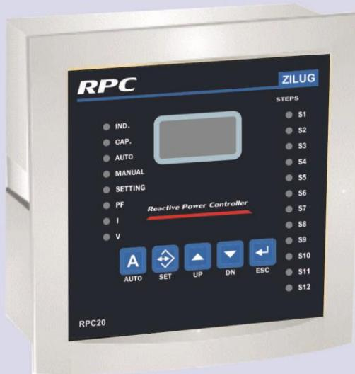
رگولاتور بانک خازنی زایلوگ یک دستگاه کنترلر اتوماتیک بانک خازنی میباشد. که این وظیفه را با جاگذاری خازنهای در دسترس انجام میدهد تا شبکه را به ضریب توان مد نظر کاربر برساند، برای نمایش کلیه عملکردهای خود از قبیل اندازه کیری ضریب توان، ولتاژ، جریان از نمایشگر سون سکمنتی استفاده می نماید. رگولاتور بانک خازنی دارای سیستم تشخیص خودکار k/c و ویژگی تشخیص مقادیر پله های خازنی برای سهولت راه اندازی میباشد. همچنین امکان تنظیم زمان دشاره خازنها و تنظیم زمان عکس العمل رکلاتور از ویژگیهای این مدل میباشد.
